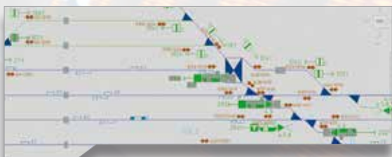
Bild 7: Ausschnitt eines Sicherungstechnischen Übersichtsplans in ProSig.
