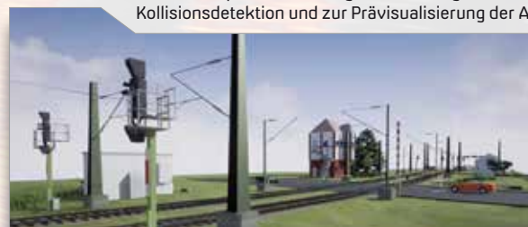
Bild 17: Beispiel für einen Digitalen Zwilling u. a. zur Kollisionsdetektion und zur Prävisualisierung der Anlage.
