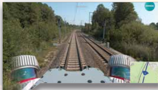
Bild 2: Streckenbefahrung und -vermessung mit einem OnBoard-Scanner/Kamera-System. (Bildquelle: Siemens Mobility)
