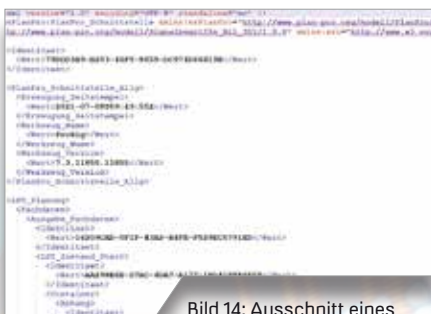
Bild 14: Ausschnitt eines PlanPro-XML-Exports aus ProSig.
